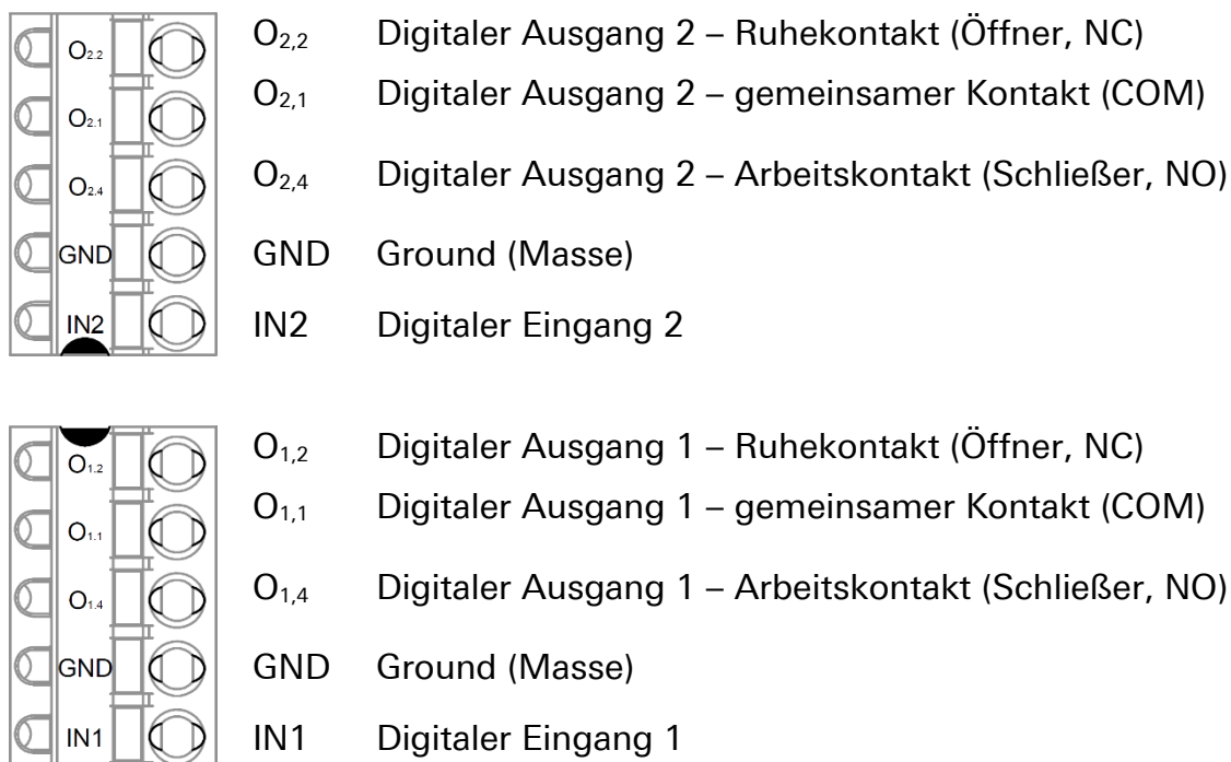
Abbildung 26: MRcard SI – Anschlüsse Steckverbinder
