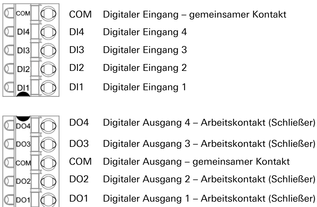
Abbildung 38: MRcard IO – Anschlüsse Steckverbinder
