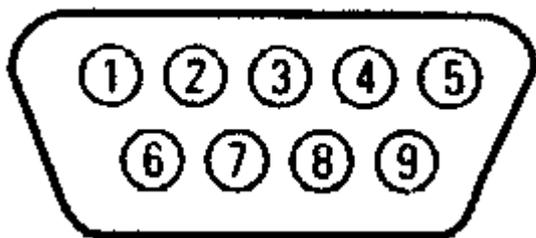
Abbildung 8: ECR – Anschluss RS232-Schnittstelle
