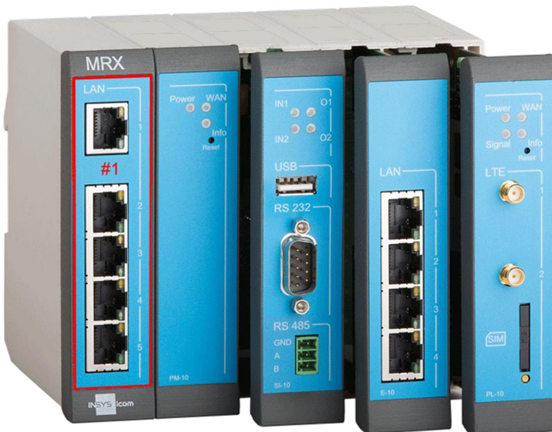
Abbildung 45: Steckplatz für 4+1-Port-Switch
