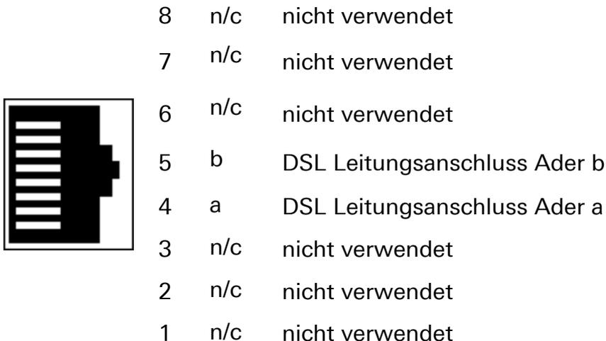
Abbildung 21: MRcard PD – Belegung DSL-Buchse
