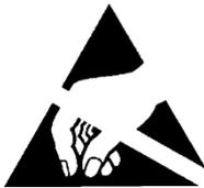
**Der MRX und die MRcards enthalten elektrostatisch gefährdete Bauteile. Elektrostatische Entladungen können diese Bauteile beschädigen!**
