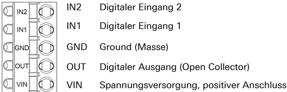
Abbildung 31: MRcard PLS – Anschlüsse Steckverbinder
